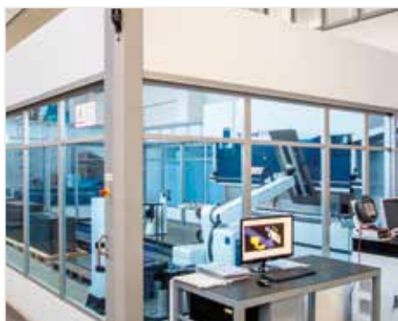
Cella di piegatura automatizzata.
